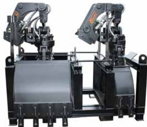
EAN82586 Transportgestell passend für 1x Zweischalengreifer Schnittbreite 300 mm 1x Zweischalengreifer Schnittbreite 800 mm 1x Ersatzrad Durchmesser 1050 mm
