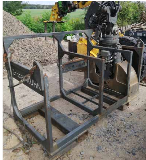
EAN82596 Transportgestell passend für 1x Tieflöffel Schnittbreite 300 mm 1x Tieflöffel Schnittbreite 750 mm 1x Tieflöffel Schnittbreite 1250 mm
