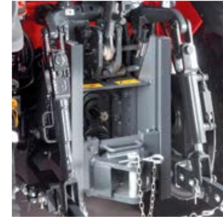
Mit schnell verstellbarem Slider\*-Zughaken wird die Anbauhöhe des gezogenen Geräts optimal eingestellt.
