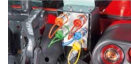
Hydraulikanlage mit elektrohydraulischer Steuerung mit Joystick: mit einem einfachwirkenden und zwei doppeltwirkenden Verteilerventilen + Hydraulikanschluss für Ölrücklauf. Insgesamt: 6 Schnellanschlüsse hinten.
