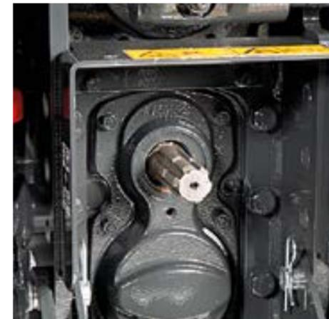
Zapfwelle mit zwei Geschwindigkeiten: 540 U/min, 540 E (750 U/min) mit den Schaltgängen synchronisiert. Der Zapfwellenstummel ist vom Typ ASAE 1 3/8 und für alle Geschwindigkeiten gleich.
