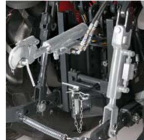
Senkrechte, hydraulische Zugstange und ein dritter Punkt\* ermöglichen die praktische Einstellung vom Bedienerplatz aus.
