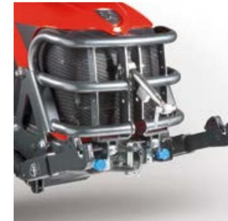
Der vordere Kraftheber\* optimiert die Arbeit bei kombiniertem Einsatz mit heckseitigen Geräten.
