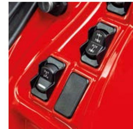
Die Sperre der hinteren Differenziale verhindert den Raderschlupf und optimiert die Traction. Das Ausschalten des Vorderradantriebs ist bei Straßenfahrten nützlich und verhindert die Beschädigung von empfindlichen Böden.
