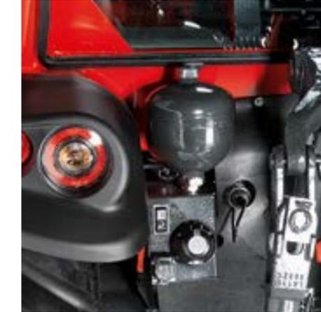
Hydropneumatische Aufhängung mit automatischer Drucksteuerung.
